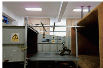
图 3 低速风洞悬停试验台
